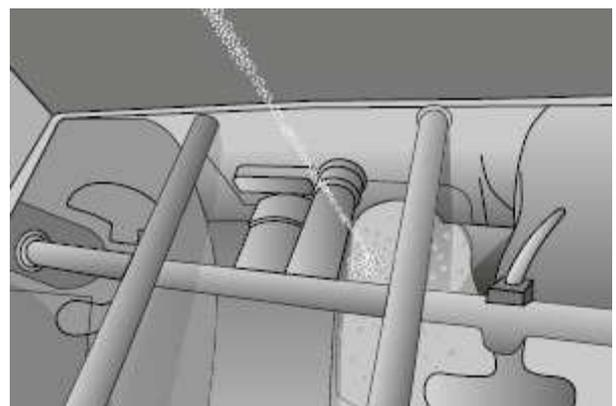
MEYCO® Lube 1 легко размешивается двумя короткими пусками насоса. После этого можно добавлять бетон и запускать насос в работу.
